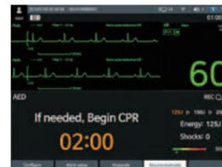
**Modo monitor:** ECG de 3 ó 5 derivaciones, monitorización opcional de SpO2, RESP, TEMP, NIBP, EtCO2, IBP y ECG de 12 derivaciones. Las mediciones de estos parámetros se presentan en la pantalla y se dispone de alarmas para alertarle de cambios en el estado del paciente. También proporciona una gran pantalla numérica.
